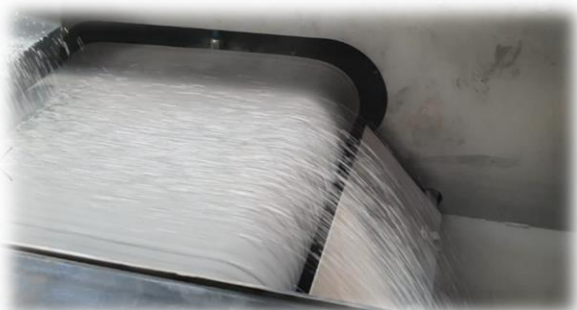
-2mm manyezit zenginleştirme sonucu ferromanyetik-paramanyetik empürterler ve zenginleştirilmiş manyezit (sağda)
