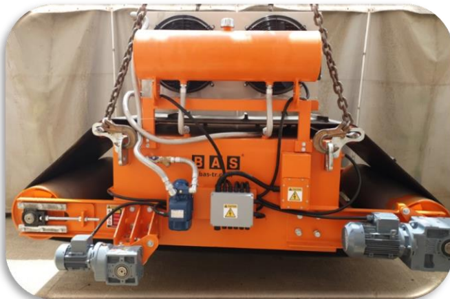
EMBS-H Serileri yüksek kapasite uygulamalar için tasarlanmıştır ve 2 katından daha fazla yüksek manyetik alan şiddeti sağlar. Ek olarak üzerinde zorlanmış ısı transferi grubu bulundurulur (pompa+fan).
